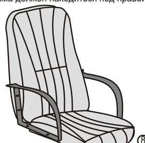
6. Сиденье установите отверстием в металлической площадке на газлаторон.
