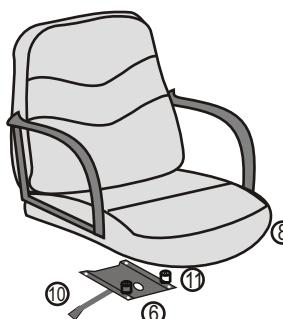
6. Сиденье установите отверстием в металлической площадке на газпатрон.
