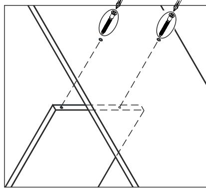
Отверстия диаметром 5 мм
